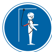
4 Sistema di arresto caduta: se utilizzato nel modo giusto, arresta la caduta della persona. L'energia cinetica sviluppata dalla caduta viene ridotta da un assorbitore di energia. Non si esclude il pericolo di lesioni.
