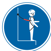
2 Un sistema di ritenuta: tiene lontana la persona dalle zone con pericolo di caduta. Se utilizzato nel modo giusto, non ci sono pericoli di caduta dall'alto.
