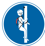
3 Un sistema di posizionamento: posiziona la persona sul luogo di lavoro. Impedisce la caduta libera. Rischio di lesioni molto ridotto.
